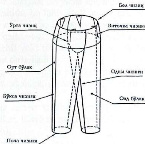
1-rasm. Shimning asosiy bo'laklari va konstruktiv chiziqlari
